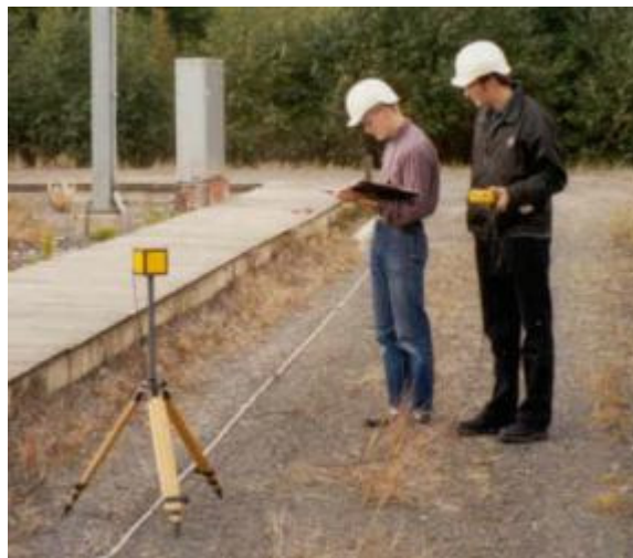
Kuva 4.9. Sähkökentän mittaus Wandel&Goltermann EFA-3 -mittarilla.
