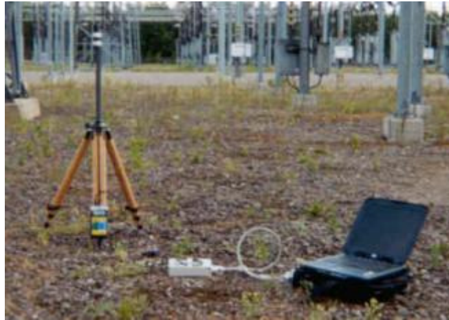
Kuva 4.7. Magneettikentän laajakaistamittauslaitteisto: kolmijalan yläpäähän kiinnitetty anturi, kolmijalan alaosaan kiinnitetty mittari, ylipäästösuodin ja kannettava tietokone.
